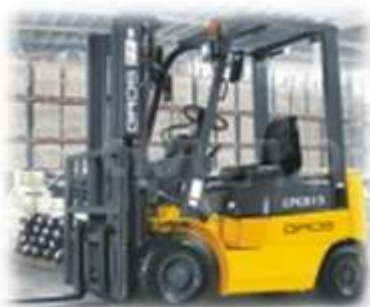
Рис. №17 Технические характеристики вилочного погрузчика г/п 1,5 тн.
